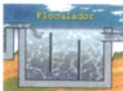
Floculação é o processo onde a água recebe a adição da substância química sulfato de alumínio. Este produto faz com que as impurezas se aglutinem formando flocos que são facilmente removidos.
